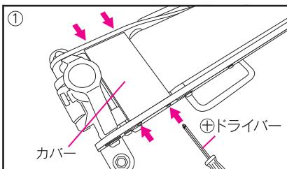
①④ドライバーでネジ4箇所をはずし、カバーをはずす。
