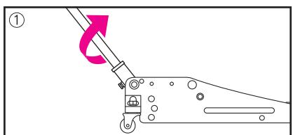
①リリースバルブがしっかりと締まった状態から左回り(反時計回り)に1~2回転させ、ゆるめる。
