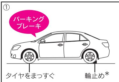
①パーキングブレーキを確実にかけ、下記「輪止めの位置」を参照しタイヤに輪止め(別売)をセットする。
