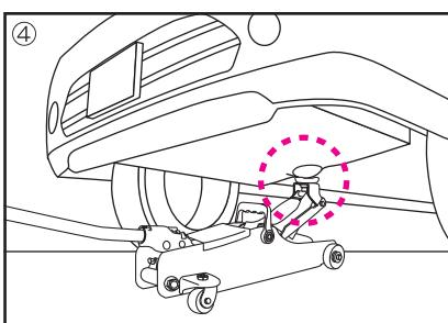
④ハンドルをハンドルスリーブに差し込み上下に動かし、サドルをジャッキセット位置付近まで上昇させ一度停止し、ジャッキセット位置の中心がサドルの中央にかかることを確認する。
