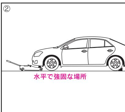
②水平で強固な場所にジャッキを置き、ジャッキセット位置\*の真下にくるようにジャッキを移動する。
