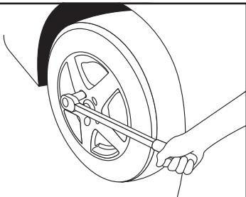
⑯ジャッキを安全な所まで移動してから、トルクレンチを使用し、規定のトルク数値でホイールナットを本締めする。
