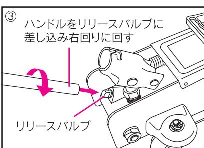
③ハンドルをリリースバルブに差し込み、右回り(時計回り)に回してリリースバルブをしっかりと締める。
