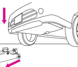
⑯車両の下に入れているジャッキスタンドをはずし、リリースバルブを左回り(反時計回り)にゆっくり回しジャッキダウンする。
