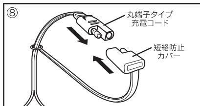
⑧充電完了後、充電コード接続カプラーをはずし、必ず短絡防止カバーを取り付ける。
