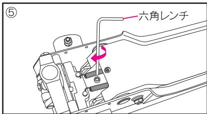
⑤ 作業が終したら、オイルプラグを六角レンチで右回り(時計回り)に締め付けて元の状態に戻し、カバーを取り付ける。
