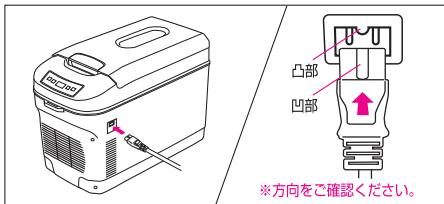
①電源コードの本体差しプラグを電源ソケットに確実に接続する。
