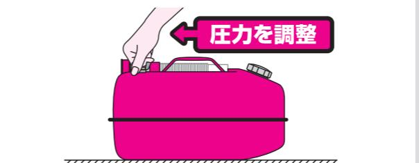
警告 内部の圧力を調整せずに給油キャップを開けると中身がふき出る恐れがあり非常に危険です。必ず圧力を調整してください。
