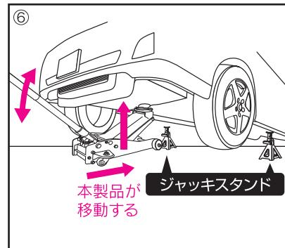
⑥ ハンドルを上下に動かしてサドルを上昇させ、ジャッキスタンドが車両の左右ジャッキセット位置に入るまでジャッキアップする。
