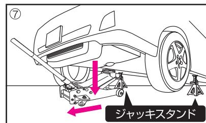
⑦ ジャッキスタンドを、車両のジャッキセット位置の真下になるよう合わせて置き、ジャッキスタンドが車両を維持するまでリリースバルブを左回り(反時計回り)にゆっくり回し、ジャッキダウンする。
