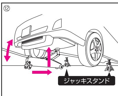
⑫作業後、再びジャッキをジャッキセット位置まで移動させ、リリースバルブを右回り(時計回り)に回してリリースバルブをしっかりと締め、ジャッキスタンドが取りはずせる位置までジャッキアップする。
