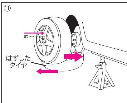
⑪交換用タイヤを取り付け。ホイールナットを手で回して取り付けた後、クロスレンチ等を用いて仮締めし、車両の下に敷いたタイヤを取り出す。
