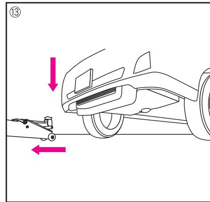
⑬車両の下に入れているジャッキスタンドをはずし、リリースバルブを左回り(反時計回り)にゆっくり回してジャッキダウンする。
