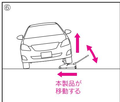
⑥ ジャッキアタッチメントがジャッキセット位置に確実に接触しているか確認後、ハンドルを上下に動かし、ジャッキアップする。
