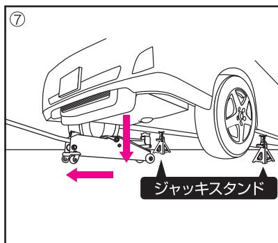
⑦ ジャッキスタンドを、車両のジャッキセット位置の真下になるよう合わせて置き、ジャッキスタンドが車両を維持するまでリリースバルブを左回り(反時計回り)にゆっくり回し、ジャッキダウンする。
