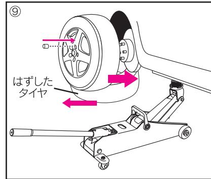
⑨ 交換用タイヤを取り付け。ホイールナットを手で回して取り付けた後、クロスレンチ等を用いて仮締めし、車両の下に敷いたタイヤを取り出す。
