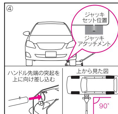
④ハンドルをハンドルスリーブに差し込み、ジャッキアタッチメントを載せたサドルを、車両のジャッキセット位置\*の下まで入れ、ジャッキアタッチメントがジャッキセット位置に軽く接触するまでハンドルを上下に動かしサドルを上げる。
