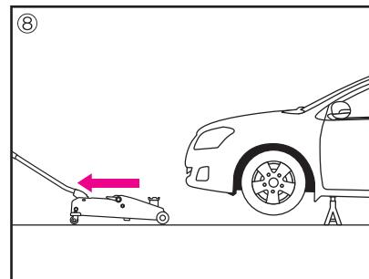
⑧ ジャッキスタンドが、車両を完全に維持しているのを確認し、ジャッキのサドルを下げて移動させる。
