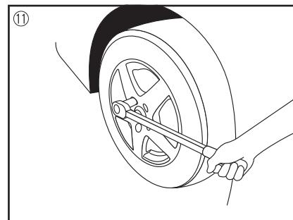
⑪ ジャッキを安全な所まで移動してから、トルクレンチを使用し、規定のトルク数値でホイールナットを本締めする。
