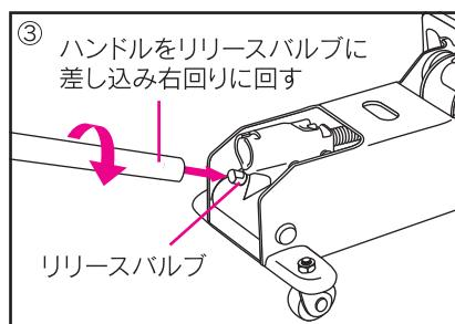
③ ハンドルをリリースバルブに差し込み、右回り(時計回り)に回してリリースバルブをしっかりと締める。
