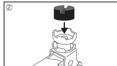
②ジャッキアタッチメントをサドルに載せる。(付属のジャッキアタッチメントを使用してください。)
