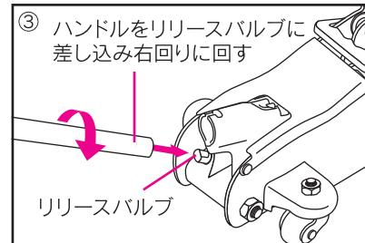
③ハンドルをリリースバルブに差し込み、右回り(時計回り)に回してリリースバルブをしっかりと締める。
