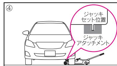
④ハンドルをハンドルスリーブに差し込み、ジャッキアタッチメントを載せたサドルを、車両のジャッキセット位置\*の下まで入れ、ジャッキアタッチメントがジャッキセット位置に軽く接触するまでハンドルを上下に動かし、サドルを上げる。
