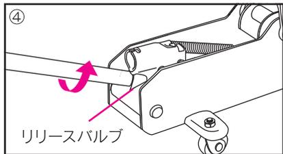
④リリースバルブをしっかり締まった状態から左回り(反時計回り)に1~2回転させ、ゆるめる。
