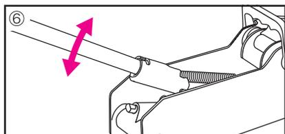
⑥ハンドルをハンドルスリーブに差し込み、すばやく5~6回可動範囲いっぱいハンドルを上下させる。作業が終了したら、オイルプラグを取り付け、元の状態に戻し、カバーを取り付ける。
