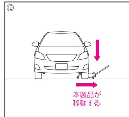
⑩ 作業後、リリースバルブを左回り(反時計回り)にゆっくり回しジャッキダウンする。
