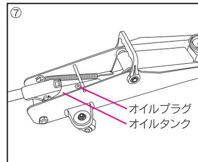
⑦作業が終了したら、オイルプラグを取り付け、元の状態に戻し、カバーを取り付ける。
