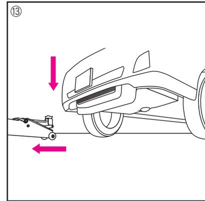
⑬ 車両の下に入れているジャッキスタンドをはずし、リリースバルブを左回り(反時計回り)にゆっくり回しジャッキダウンする。
