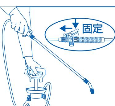
スプレーを持ち、手元のレバーを押すと噴射されます。また、レバーを押したまま、ノズル側にスライドさせると固定することができます。
