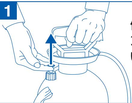
使用前に減圧バルブを上に引いて、タンクに残っている空気を抜いてください。
