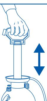
ハンドル部を手動で上下に操作し、圧力を加えます。
