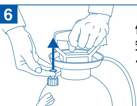
使用後は、減圧バルブを上に引いて空気を抜き、タンクに残った水を捨て、よく乾かした後収納してください。
