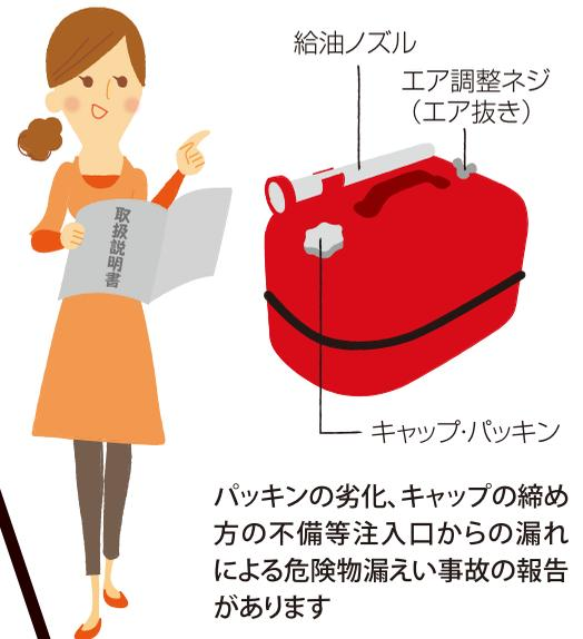
パッキンの劣化、キャップの締め方の不備等注入口からの漏れによる危険物漏えい事故の報告があります
